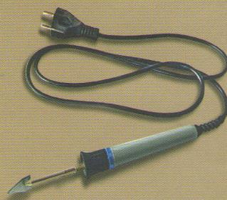
Электрический паяльник с нагревающимся компенсатором предназначен для удобного нанесения твердого воска. При нагревании не изменяет цвет материала и не повреждает лаковое покрытие изделия. Паяльник нагревается до температуры не выше 95°C, что гарантирует бережное плавление твердых восков. Внимание: нагрев воска до более высоких температур может привести к потере эластичности и нарушению способности удерживаться на поверхности.
