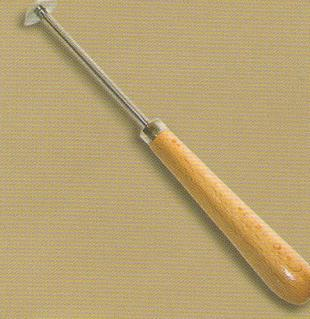
Скребок применяется для удаления излишков левкаса и выравнивания грунта при подготовке поверхности к золочению. Овальная форма удобна для работы с изделиями сложных форм. Скребок изготовлен из стали.
